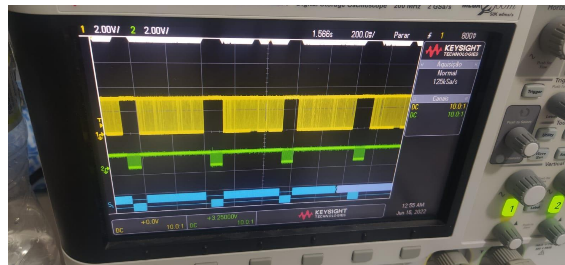
Fig.2: Comunicação de duas vias com uma rede rodando a aplicação do SAGA1000 (protocolo ABNT com comunicação serial de duas vias).
