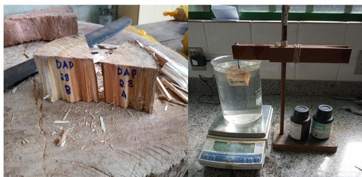
Figura 1. Determinação do volume das cunhas de madeira.
