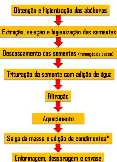
**Figura 1.** Fluxograma do processo de fabricação do produto tipo queijo ricota produzido a partir da semente de abóbora.
