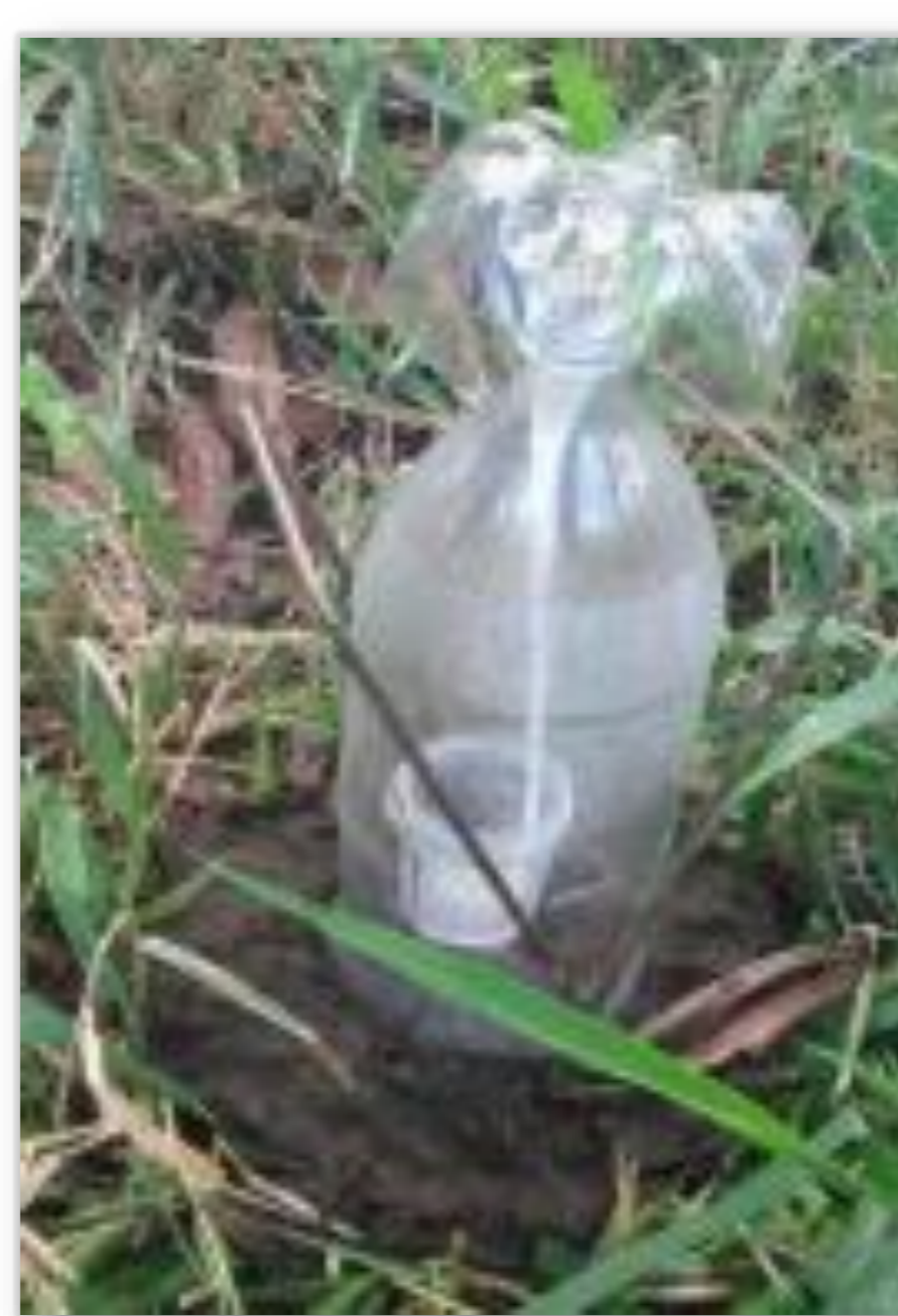
Figura 1 - Câmara estática semiaberta utilizada para quantificação da volatilização de NH_3 .
