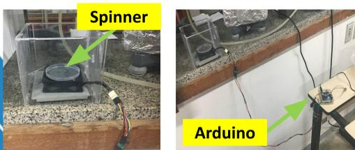
Figura 1- Spnner de baixo custo que foi confeccionado. A automação foi feita utilizando o Arduino. O Arduino é um microcontrolador dotado de Hardware livre e programável com capacidade de processamento que possibilita a implementação de sistemas automatizados através da operação de entradas e saídas elétricas.
