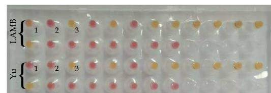
Figura demonstrando reações de LAMP feitas com 3uL RNA oriundo de extração automatizada. Como indicado na imagem, cada amostra foi replicada com cada conjunto de primers, seguindo o padrão representado por 1,2 e 3.
