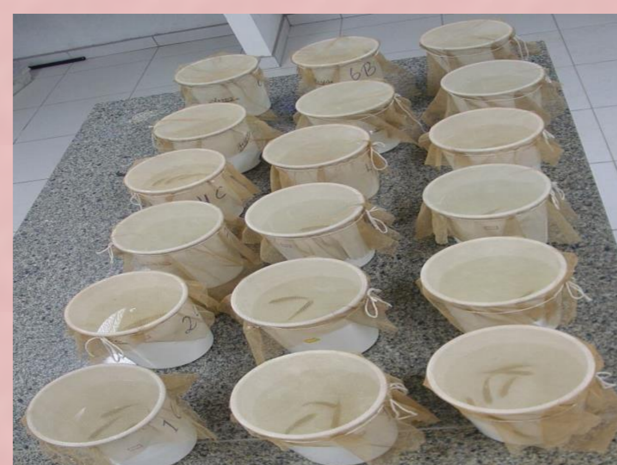
Figura 2: Experimento em laboratório. Distribuição de peixes nas diferentes concentrações no teste de CL 50 -96h para alumínio.
