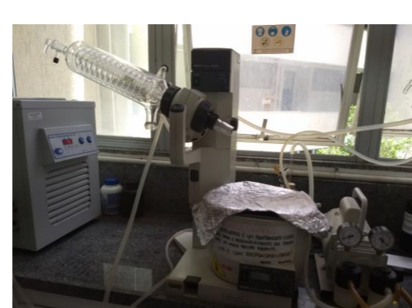
Figura 4: Equipamento rota vapor utilizado para evaporar os solventes usados para a obtenção dos extratos.
