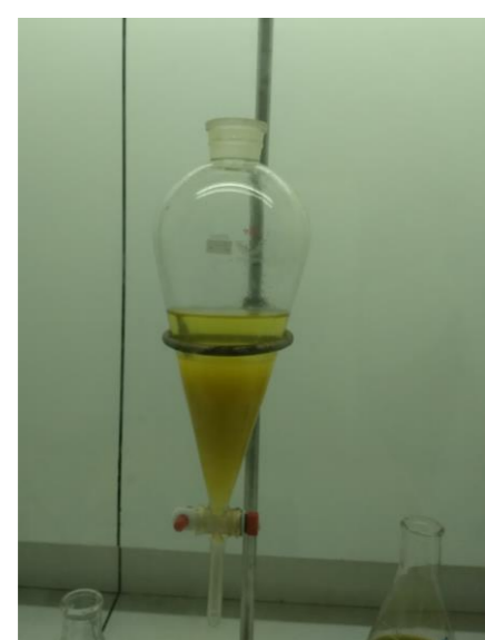
Figura 1: Funil de separação mostrando as duas fases, aquosa e orgânica, durante o fracionamento biomonitorado.
