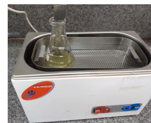
Figura 3: Extrato bruto etanólico sendo solubilizado em solvente hexânico com auxílio do equipamento ultrassônico.
