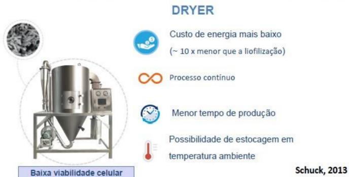
Figura 1: Vantagens e desvantagem da secagem por spray dryer comparada a liofilização.
