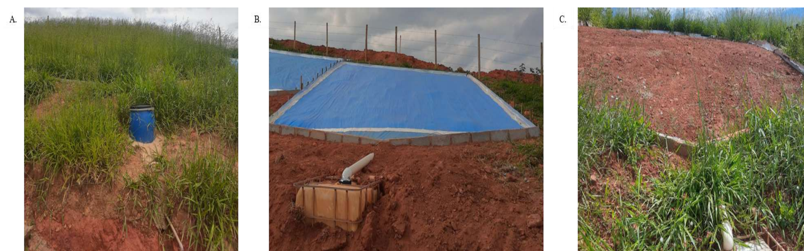
Figura 2 - Parcelas coletoras de escoamento superficial: Parcela com cobertura de Brachiaria sp. (A); parcela com cobertura impermeável (B); parcela com solo exposto (C).
