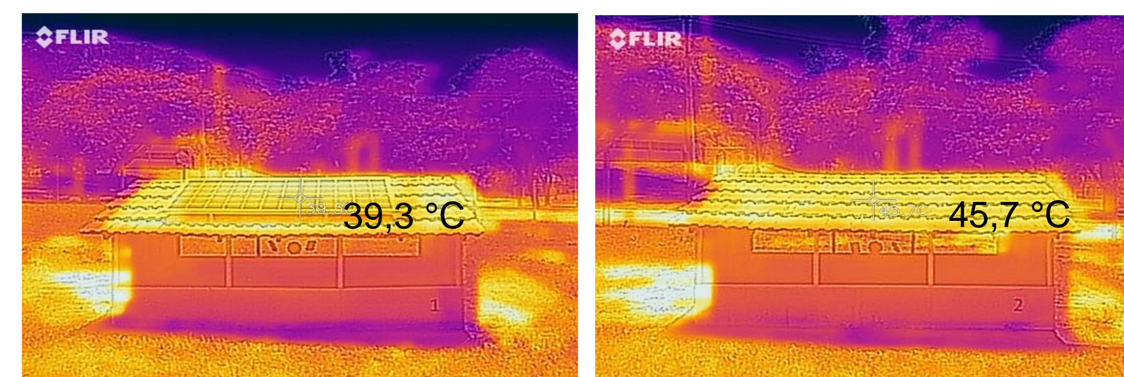
Figura 3. Imagens termográficas dos protótipos com e sem painel solar fotovoltaico às 12:00 horas
