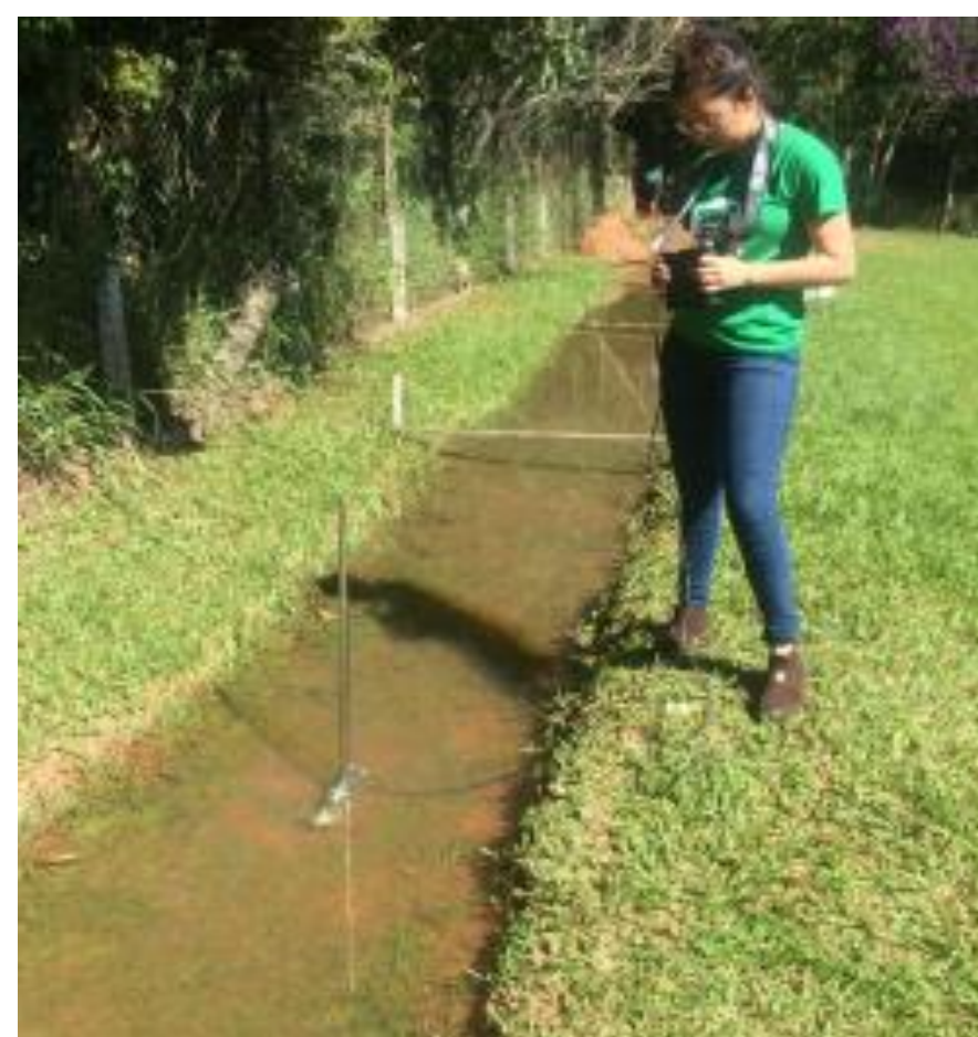
Figura 1 - Testes realizados com o molinete fluviométrico
