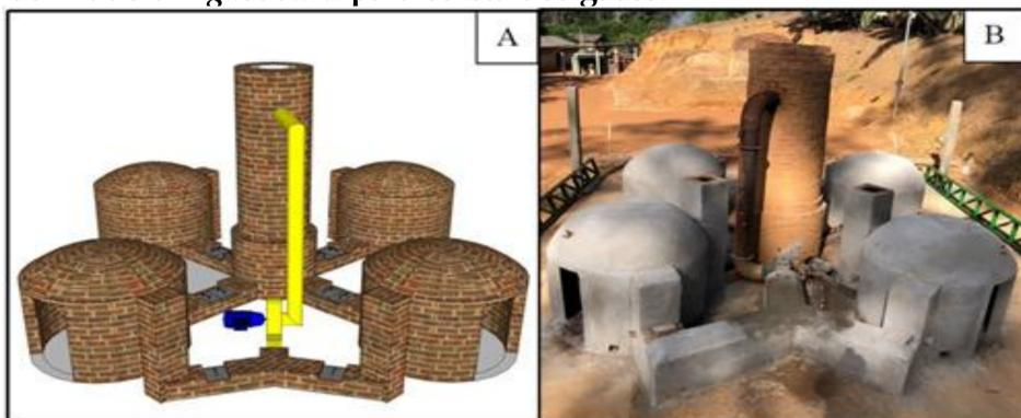
Figura 1. (A) Representação esquemática do sistema para condução de gases combustos do queimador. (B) Implantação do sistema para condução de gases combustos do queimador.
