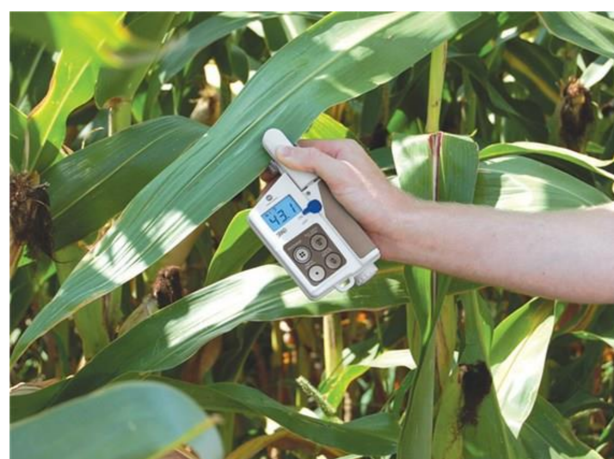
Figura 2 – Exemplo de uso do clorofilômetro na cultura do milho (Fonte: https://www.alphaomega-electronics.com/img/cms/Spectrum%20Technologies/SPAD-502-Demo.jpg ).
