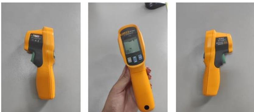
Figura 1 – Pirômetro FLUKE 62 MAX utilizado no experimento
