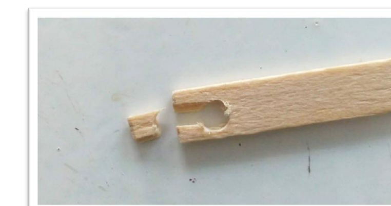
Figura 4: Corpo de prova após ensaio de cisalhamento longitudinal.
