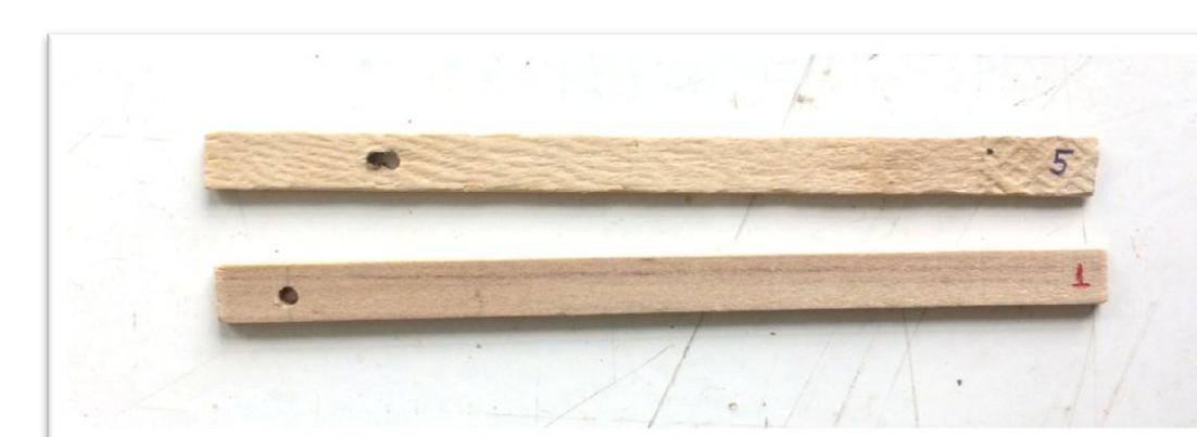
Figura 3: Corpo de prova após ensaio de esmagamento.
