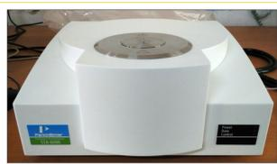
Simultaneous Thermal Analyzer utilizado para a análise termogravimétrica
