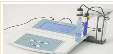
pH metro W3B da BEL Engineering associado com eletrodo universal de vidro de resistência interna de 250 MOms a 25°C, da IONLAB, utilizados para a titulação potenciométrica
