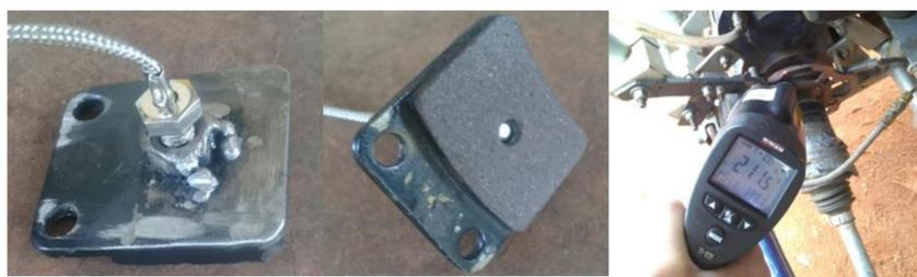
Figura 1 – Termopar tipo k e Termômetro Instrutherm TI-920
