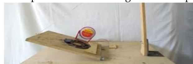
Figura 2 – Aparato para medir o coeficiente de atrito
