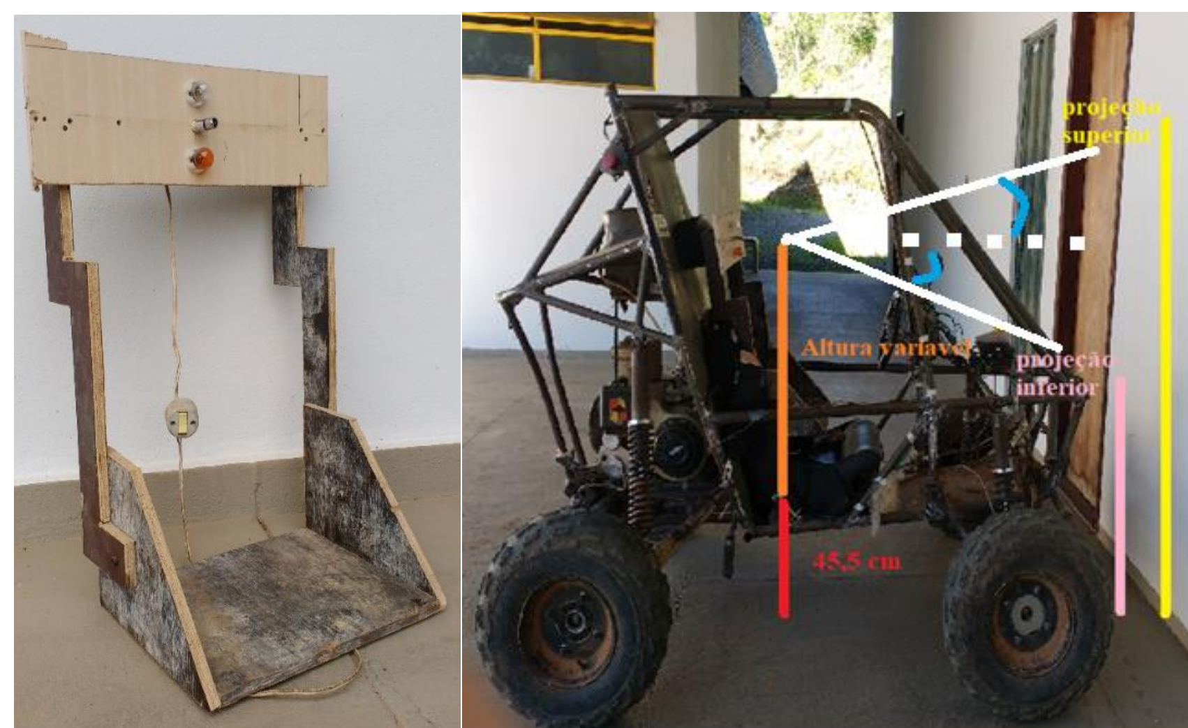
Figura 2. Aparato e sua disposição no veículo para obtenção do campo de visão experimental
