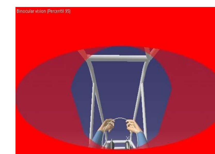
Figura 3. Simulação do campo de visão gerada pelo software CATIA
