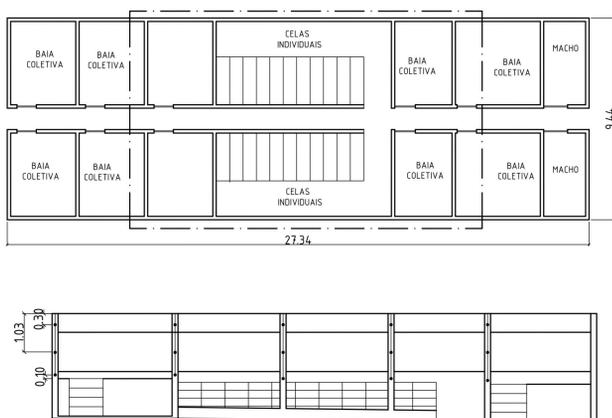
Figura 1 – Disposição dos sensores no centro da instalação de reprodução de suínos. Medidas em metros. (a) vista superior, (b) corte longitudinal
